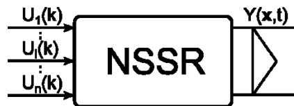
Obr. 3 Nelineárny systém so sústredeným vstupom a rozloženým výstupom.
